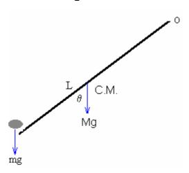
$I_O$  es el momento de inercia de la varilla respecto de un eje perpendicular a la misma que pasa por su extremo O. (teorema de Steiner):
