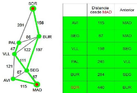
Figura 6: Resultado final según el algoritmo
